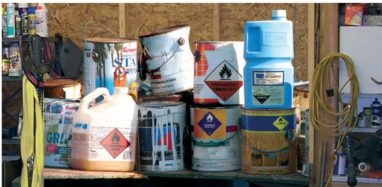
Εικόνα 14. Λανθασμένος τρόπος αποθήκευσης των χημικών παρασκευασμάτων στο χώρο εργασίας.
