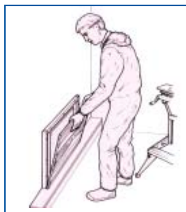
Προστασία αμιαντούχου υλικού με τοποθέτηση ενός μη αμιαντούχου πλαισίου
