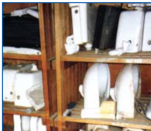
Ενισχυμένες με αμίαντο λεκάνες τουαλέτας
