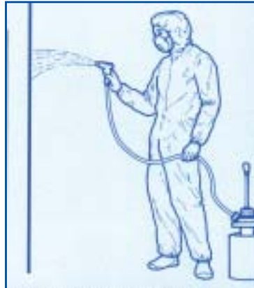
Ύγρανση μονωτικής αμιαντόπλακας με ψεκασμό
